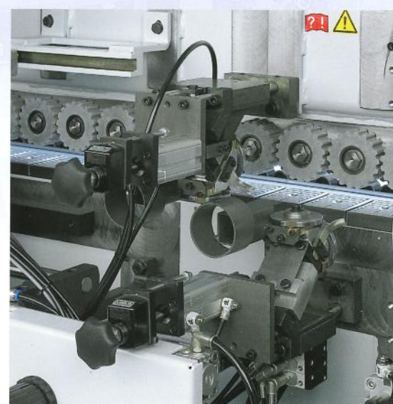
Profilziehklingenaggregat (KDN 530 C - KDF 540 GC) Aggregat zum Glätten von Radien oder Fasen.
