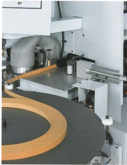
Einzugsvorrichtung (optional) Automatischer Kanteneinzug zum schnellen Kantenwechsel zwischen unterschiedlichster Rollenware.
