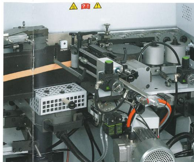
Magazin Rollen- und Fixlängenmagazin mit optischer Kantenüberwachung für sichere Materialzufuhr.
