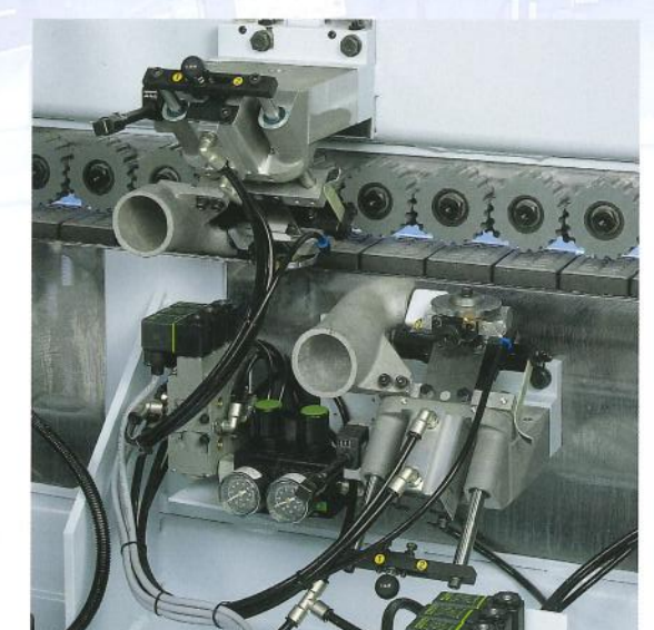
Profilziehklingenaggregat (KDN 550 C - KDF 560 GC) Aggregat zum Glätten von Radien oder Fasen, ausgestattet mit Wechselköpfen für schnellen Profilwechsel.
