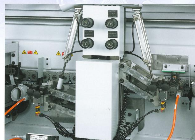
Formfräsaggregat (KDN 550 C - KDF 560 GC) Zum Eckenrunden von Dick-PVC-Kanten sowie Kopfkanten an Post- und Softformingteilen. Ausgerüstet mit automatischer Verstellung zwischen Dünn- und Dickkante. Werkstückdicke 60 mm.
