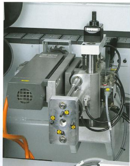
Nutfräsaggregat Aggregat zum Nuten von Schubkästen bzw. Nuten zur Aufnahme von Rückwänden.
