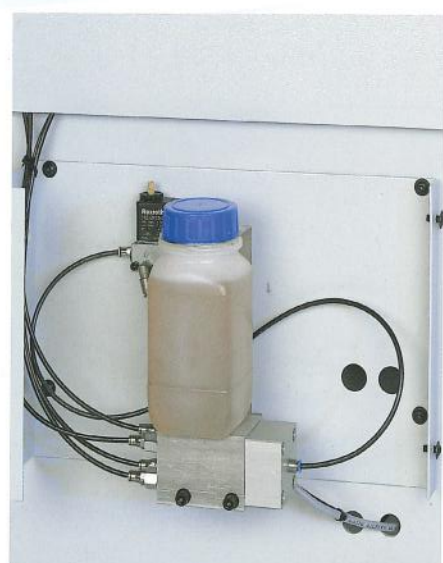
Zentral-Schmiereinheit Vollautomatische Schmierung der Kettenbahnführung für einen langlebigen und präzisen Lauf der Transportkette.
