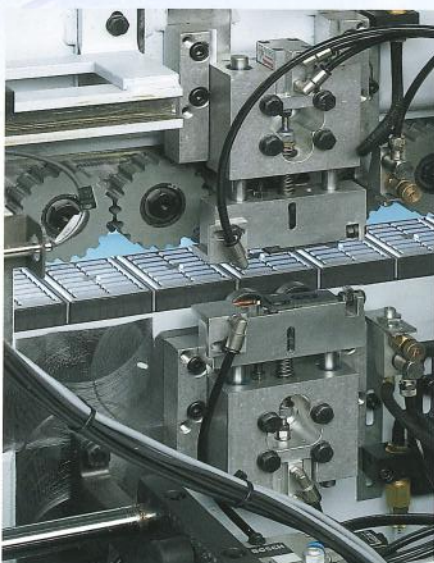
Flächenziehklingenaggregat (optional) Zur Nachbearbeitung im Leimfugenbereich. Optional mit Trenn- und Reinigungsmittel für maximale Sauberkeit.
