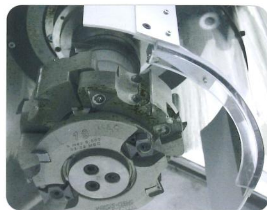
Dispositivo paratrucioli (Nuovo Brevetto) | Chip guard device (New Patent)
