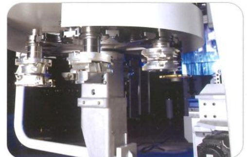
Magazzino rotativo a bordo trave Rear rotary tool changer Almacén rotativo montado sobre el carro
