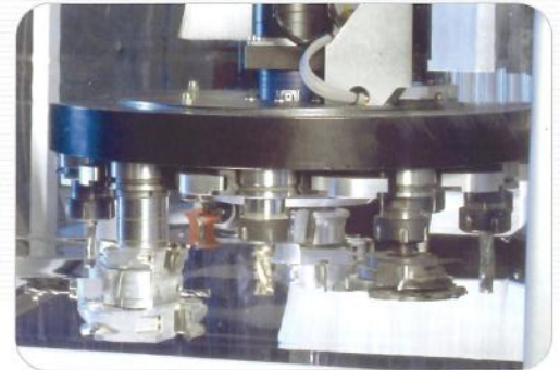
Magazzino rotativo a bordo testa Head mounted rotary tool changer Almacén rotativo montado en la cabeza
