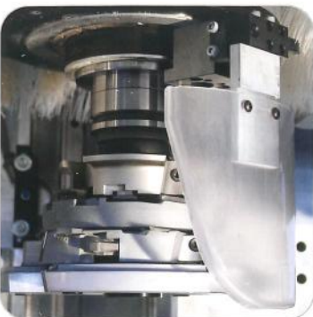
Dispositivo paratrucoli Chip guard device Dispositivo paravirutas
