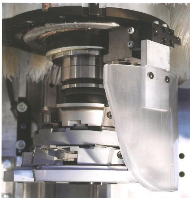
dispositivo paratrucioli su elettromandrino chip guard device on electrospindle dispositivo para/virutas sobre electromandril
