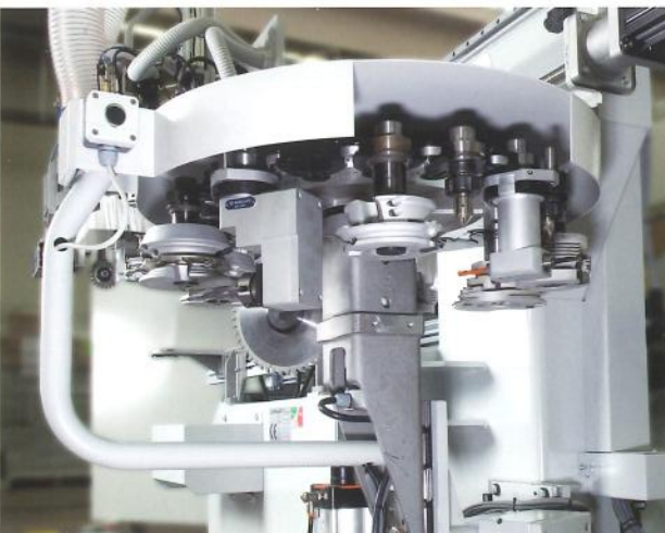
magazzino rotativo posteriore a 24 postazioni 24-position rear rotary tool changer almacen rotativo posterior a 24 posiciones
