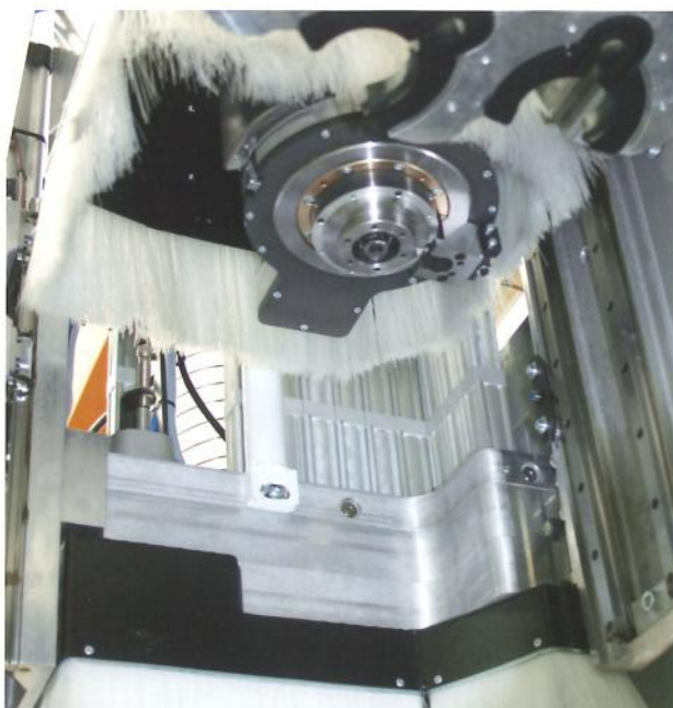
aspirazione su gruppi operatori dust extraction for working units aspiracion sobre grupos operadores
