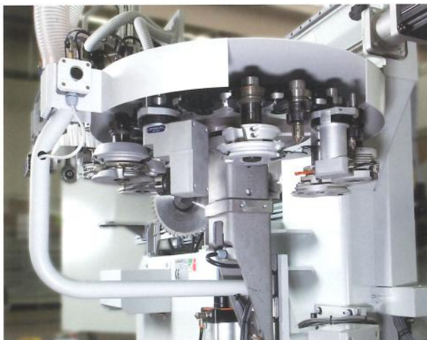
24-position rear rotary tool changer hinteres Werkzeugmagazin mit 24 Positionen magasin rotatif arrière à 24 positions
