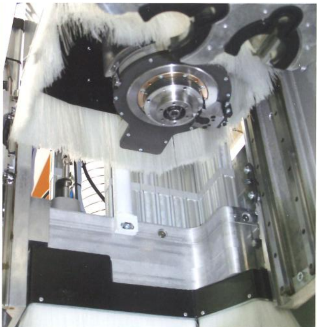
dust extraction for working units Absaugung auf Arbeitseinheiten aspiration sur unités d'usinage
