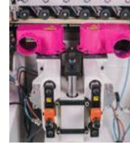
Ön Freze Ünitesi (0-3 mm) Pre Milling Unit (0-3 mm)
