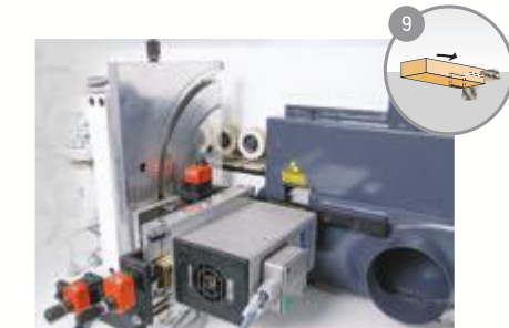
Jumpingli Kanal Freze Ünitesi (90° döner) Jumping Grooving Saw Unit (90° tilting)
