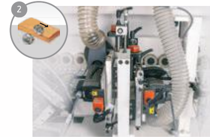
Freze Ünitesi 0°-20° Eğimli Milling Unit Tilting 0°-20°
