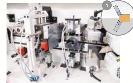
Solüsyonlu Radyus Kazıma Ünitesi (PVC Kazıma) Scraper Unit with Cleaning Agent (PVC Scraper)
