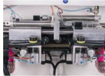
EKS Otomatik Ön Siper Ayarı Ön Frezenin yapacağı temizlik miktarını belirler. Automatic Fence Adjustment with ECS Adjusts the premilling distance from the edge.
