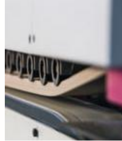
V Kayışlı Üst Baskı Ünitesi Top Pressure Beam with V Belt
