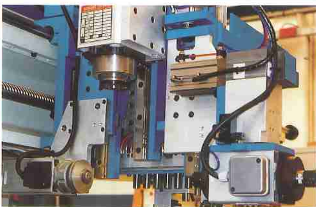
Composizione testa operatrice Edit: lama a scanalare, elettromandrino cambio utensile, fresatore orizzontale. Edit head assembly: grooving blade, tool change electrospindle, horizontal router.
