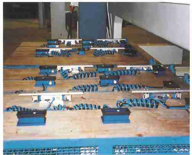
Tavolo di lavoro con ventose a doppio vuoto. Working table with double side vacuumcups.
