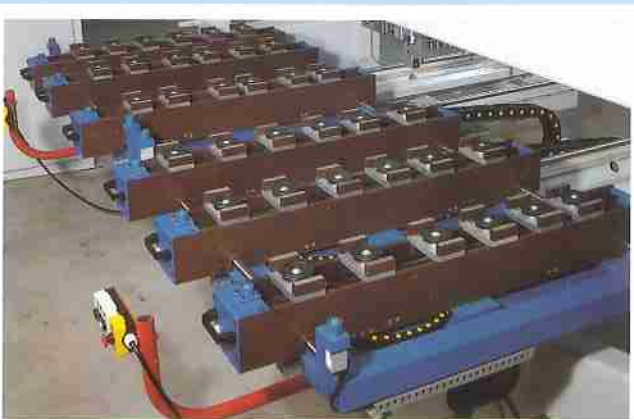
Tavoli Format equipaggiati con ventose \varnothing 85 mm. Format tables equipped with \varnothing 85 mm vacuum cups.
