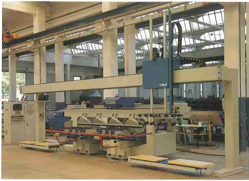
Format 90 con sistema di carico/scarico automatico. Automatic loading/unloading system on Format 90.
