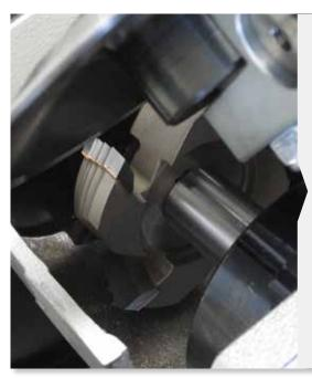
Possibilità di lavorare bordi con 3 diversi raggi: con l'utilizzo dei gruppi operatori multiedge completamente automatici, che permettono anche il set up rapido e senza errori tra le diverse lavorazioni.
