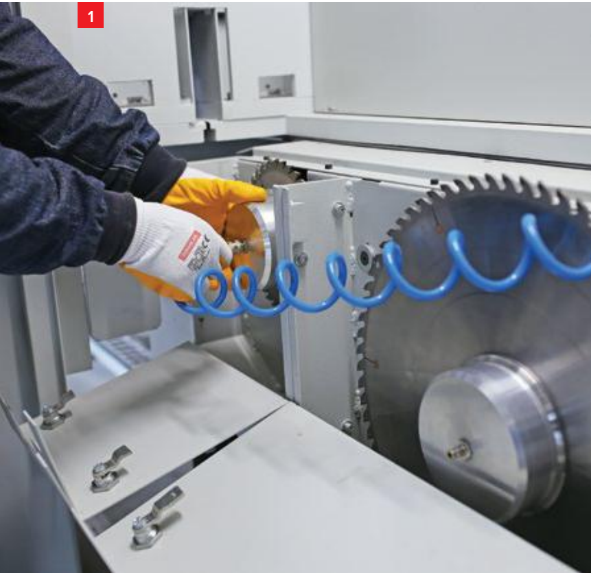
1 Testere Değişirme Saw Changing
