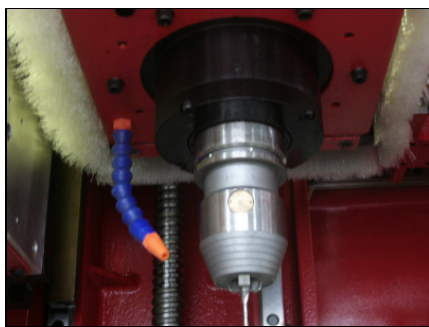
Hauptfrässpindel mit eingesetztem NC-Bohrfutter.
