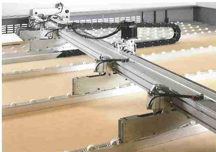
Le chariot pousseur permet un positionnement rapide et précis des pièces; il est actionné par un servomoteur brushless à technologie digitale sous supervision directe du contrôle numérique. Le plan de coulissemement, sous le pousseur, a des galets fous indépendants pour éviter d'abîmer les pièces délicates.
