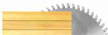
La saillie de la lame principale et l'ouverture du presseur se règlent automatiquement par la commande numérique en fonction de l'épaisseur de la pile à débiter afin d'obtenir la meilleure qualité de coupe possible dans n'importe quelles conditions.
