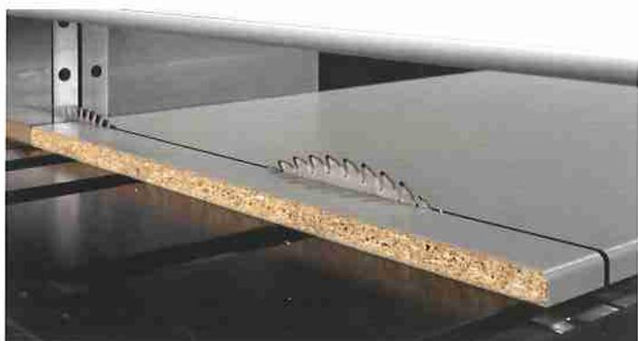
Dispositif pour la coupe de panneaux soft et post-formés. Un programme spécial du contrôle garantit une découpe parfaite aussi bien en entrée qu'en sortie de la lame, évitant ainsi que des matériaux fragiles et délicats ne soient endommagés.
