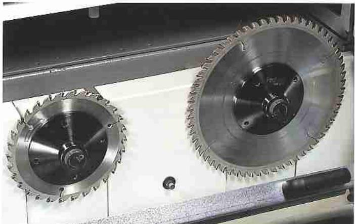
La zone du changement lames se trouve à côté de l'équerre et on peut y accéder sur le devant. Le remplacement des outils (Pro-Lock) se fait de façon rapide et sûre avec une seule clé.
