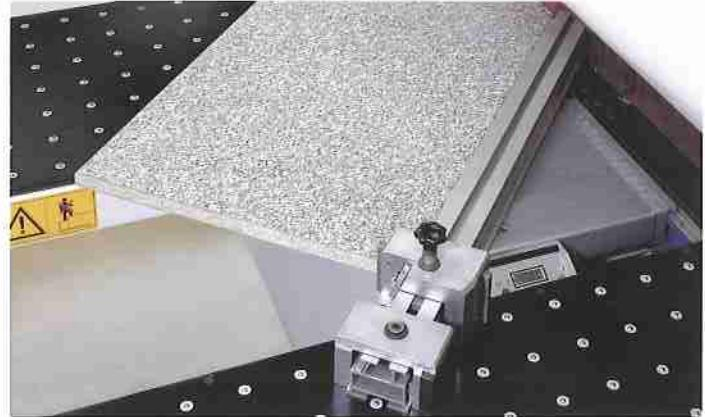
**Dispositif pour découpes inclinées avec réglage infini et lecture par afficheur numérique.**
