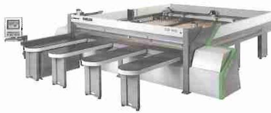
Le contrôle numérique OSI (Open Selco Interface) permet une gestion automatique des schémas de coupes, même les plus complexes, avec l'optimisation des déplacements des axes intéressés. La saillie de la lame de la pile à découper, toujours optimale, ainsi que le choix de la vitesse de coupe la plus adaptée à la hauteur de la pile et de la largeur des délignages, permet d'obtenir toujours une qualité de découpe excellente.
