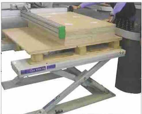
**Table hydraulique pour l'empilage sur palette du matériel usiné par la scie à débit. La table a une butée de référence réglable manuellement qui s'escamote pour faciliter l'élimination de la palette.**
