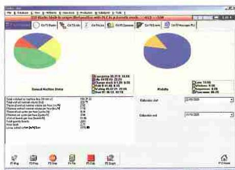
Enregistrement de tous les événements et conditions opératives avec la possibilité d'élaborer des statistiques de production et de fonctionnement de la machine.
