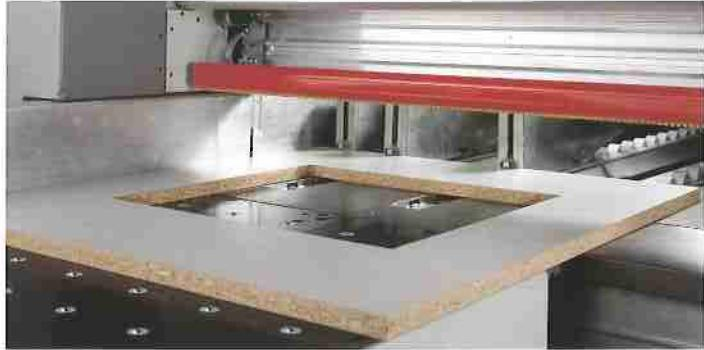
**Logiciel pour éditer et exécuter des découpes pour les fenêtres. Les divers schémas peuvent être enregistrés dans la commande.**
