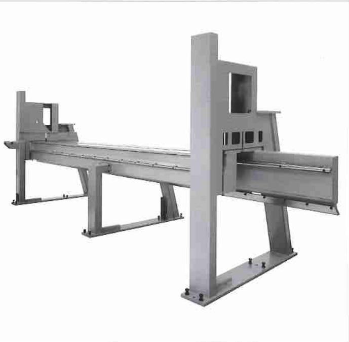
Le bâti principal de la machine est formé d'une structure monolithique en acier normalisé et de supports solides qui en assurent la parfaite stabilité. Les guidages sont cémentés et calibrés pour en garantir la longévité et une extrême précision de coupe.
