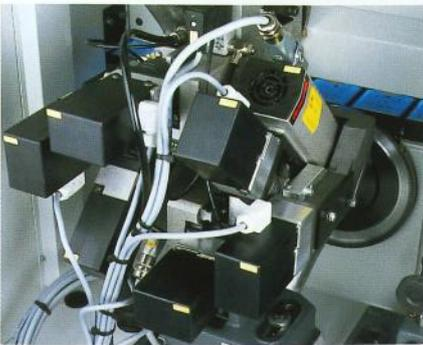
**Multifunktionsfräsaggregat 1824 MOT6**
