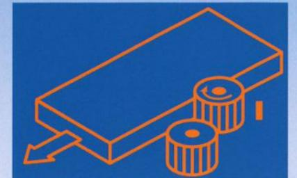
Der Einlaufbereich mit Fügefräsaggregat (1321), automatischem Magazin für Rollen- oder Streifenware, Kleberauftragsstation und Druckwerk sorgt für eine perfekte Verklebung der Kante an die Platte.
