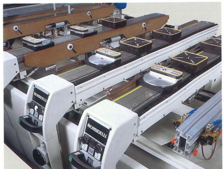
**FET (Fast Electronic Table),** Die Lösung, um einen Halbtisch der Maschine auszurüsten, während die Maschine auf der anderen Hälfte arbeitet; die Zeiten für diesen Vorgang liegen also innerhalb des Arbeitszyklus der Maschine, der dadurch nie unterbrochen wird.
