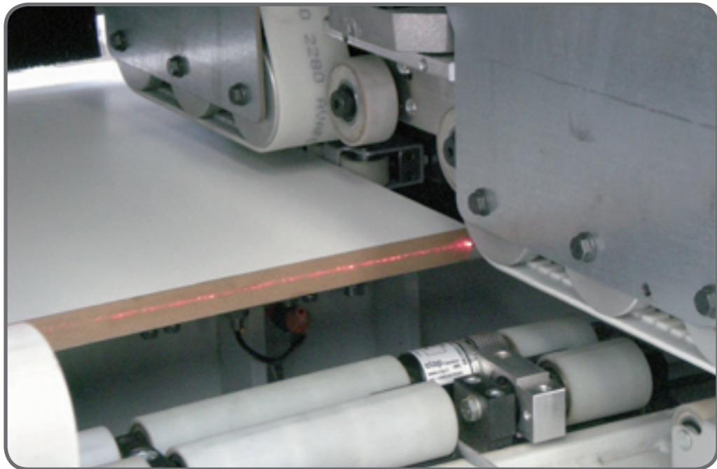
Sensore pannello con "doppio zero" ;fotocellula laser per la lettura automatica dell'origine di misurazione sia di inizio, che di fine pannello. Con questo dispositivo la Point 2 corregge automaticamente errori di taglio ed assicura un perfetto assemblaggio fra pannello orizzontale e pannello verticale.
